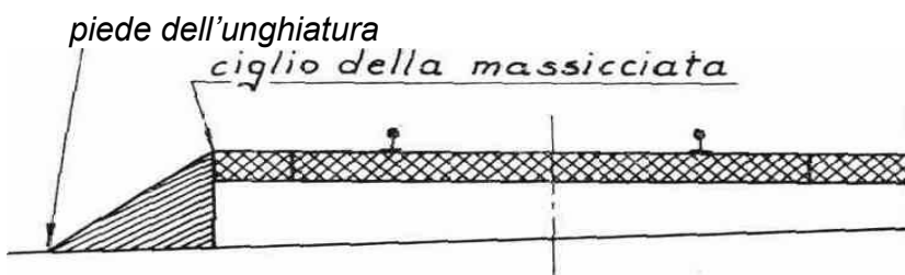
fig. 7 - Sezione della massicciata per linee a doppio binario
